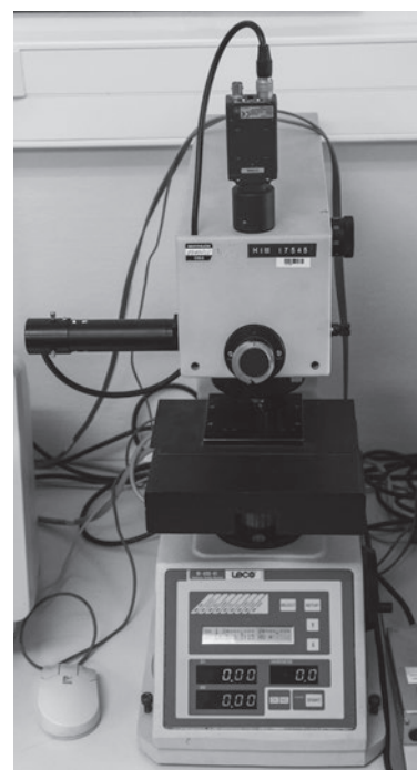
Mikrotvrdměr LECO M400-H1 slouží k hodnocení cementovaných vrstev ocelí. Lze jej také využít k dalším aplikacím, včetně strukturního měření.
