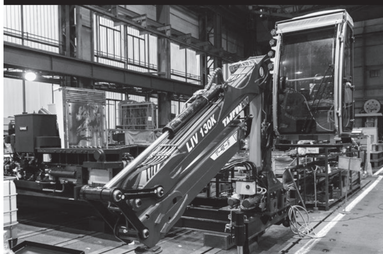
Na montáži haly 4 probíhá v těchto dnech kompletace již pátého paketovacího lisu CPB 100 s hydraulickou rukou uloženého na kontejneru. Lis je určený pro společnost HULMAN – kovošrot s.r.o. v Pohořelicích.
