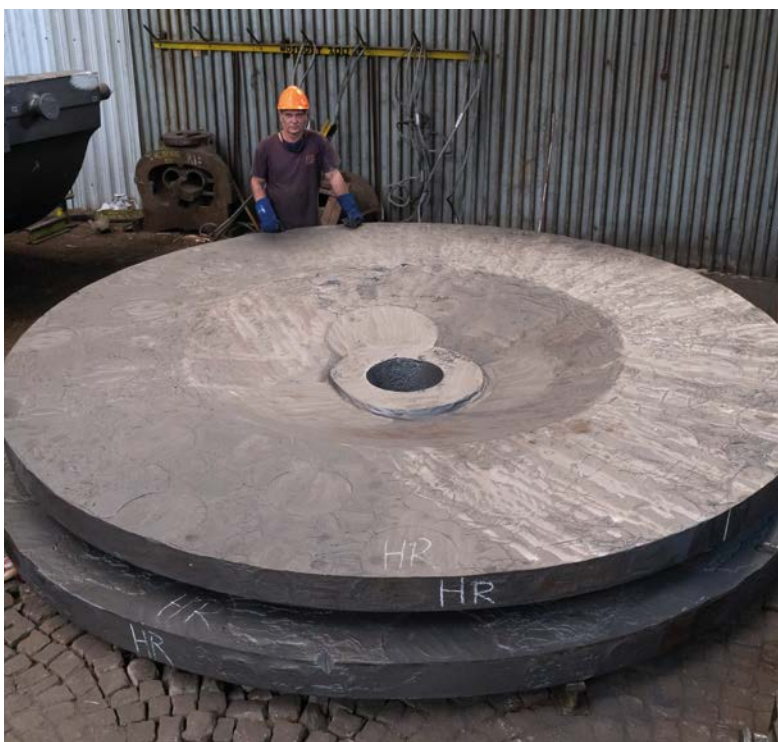
Odlitky mlecích kol pro uhelné elektrárny před hrubováním
