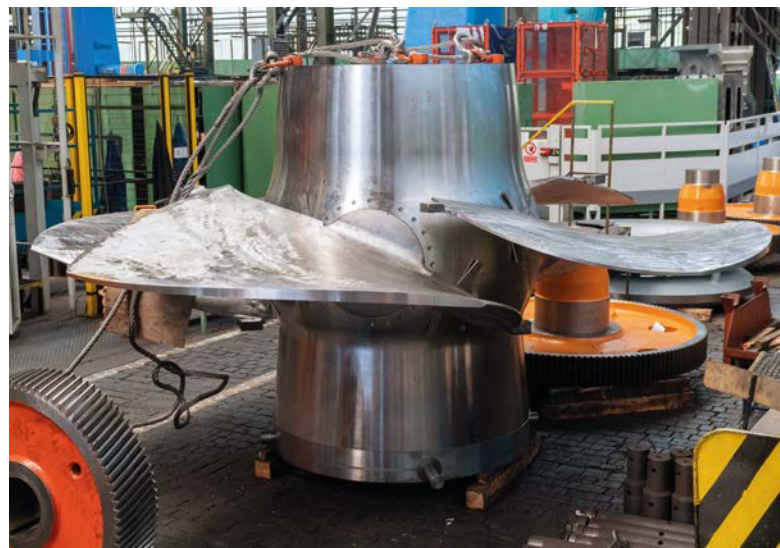
Počátkem července bylo zkompletováno oběžné kolo Kaplanovy turbíny pro společnost Litostroj Engineering. Oběžné kolo je určeno pro vodní dílo Kamýk TG2. Na fotografii je díl zachycen ve fázi finálního opracování průměru lopatek v provozu Strojíren.
