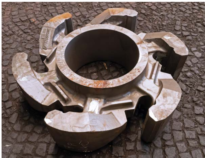
Divize Metalurgie vyrobila první zkušební kus rotorového kola pro německého výrobce drtičů kamene.
