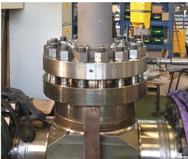
Aplikace austenitické oceli ChN35VT pro výrobu svorníků armatur určených pro jaderný průmysl ve společnosti ARAKO Opava. Ocel ChN35VT, s českým ekvivalentem 17335, patří do skupiny austenitických žárupevných korozivzdorných Cr-Ni-W-Ti ocelí. Kromě žárupevnosti podmíněné legováním wolframu je ocel stabilizována titanem pro zajištění dobré odolnosti proti mezikrystalové korozi.
