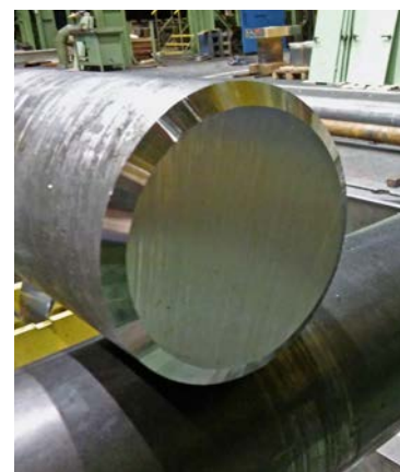
Unikátní konstrukce zařízení umožní zákazníkovi odhrotovat dva konce tyčí současně.
