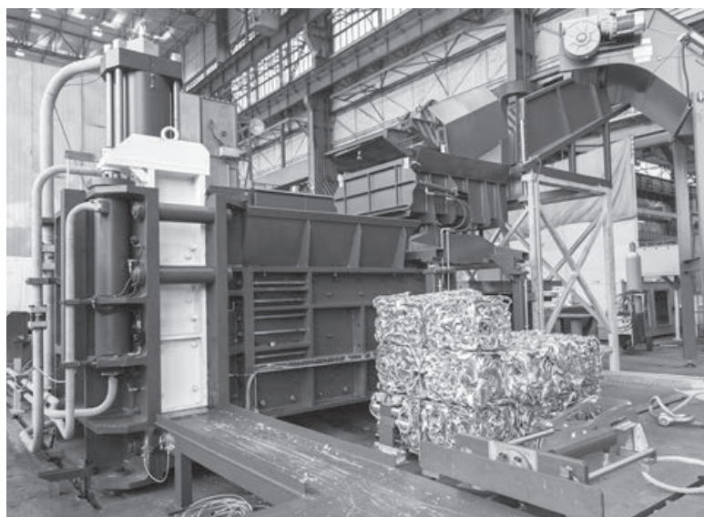
V červenci byla na montáži haly 5 smontována a odzkoušena linka s lísou CPS 180 pro firmu Strojmetal Aluminium Forging, s.r.o. Lis byl v polovině července expedován k zákazníkovi a předán do zkušebního provozu. Linka bude sloužit k paketování odstřížků výrobků při kování hliníkových slitin. Při výrobě s více než dvaceti částečně i plně automatizovanými kovacími zařízeními vzniká velké množství odstřížků výrobků z hliníkových slitin ukládaných do HAKI beden, které se následně pakují a rovnají na palety. Od roku 2002 společnost pro paketování využívala hydraulický paketovací lis CPB 100 s hydraulickou rukou. Ten bude nahrazen linkou s lísou CPS 180.
