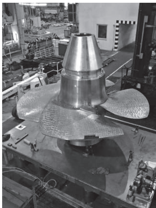
Záběr ze statického vyvažování soustavy oběžného kola pro vodní dílo Kamýk.
