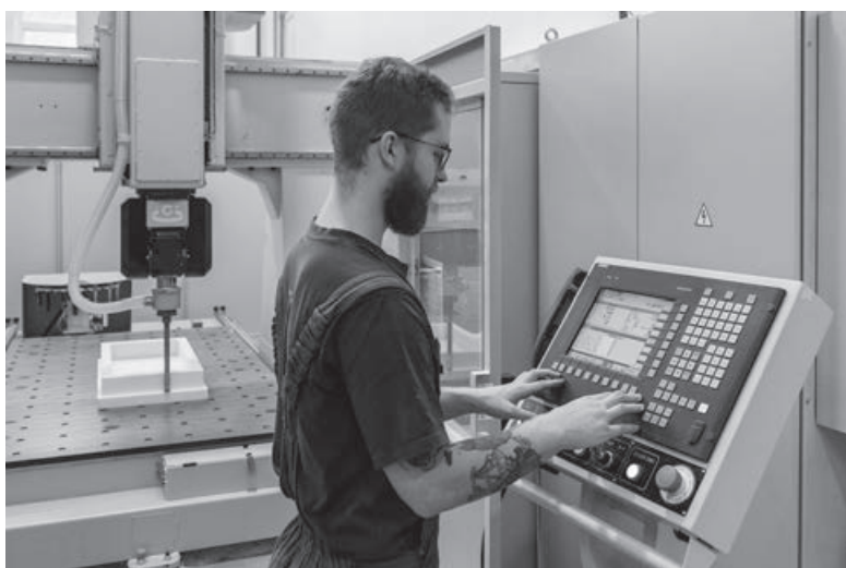
Od ledna letošního roku využívá provoz Modelárny nové CNC obráběcí centrum TAURUS X5. Zařízení v hodnotě asi 4 miliony korun slouží k obrábění modelů jak ze dřeva nebo spárových desek, tak z polystyrenu. Umožňuje obrábět v pěti osách a je proto velmi efektivní zejména při obrábění složitých tvarů. Na fotografiích pracovník obsluhuje pan Michal Novotný kontroluje parametry obrábění na ovládacím pultu.
