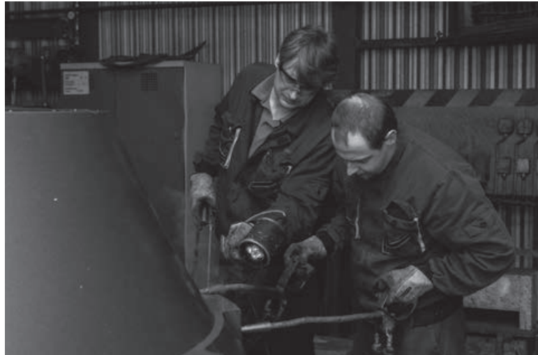
Na pracovišti nedestruktivních zkoušek na hale 5 provádí zaměstnanci defektoskopie (na fotografiích zleva) pan Petr Fusek a pan Raimund Musil magnetickou zkoušku na šestnáctitunovém odlitku náboje do Francisovy turbíny. Odlitek byl vyroben pro českého zákazníka, ale místem provozu bude ruská stanice UST Khantayskaya.
