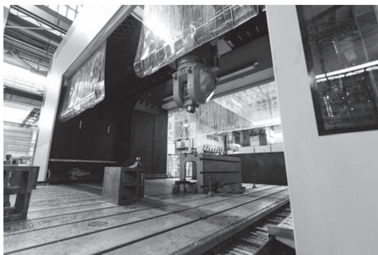
V provozu Nástrojárny bylo instalováno nové pětiosé obráběcí CNC centrum FRF 300/6, určené k obrábění zejména tvarově složitých ocelových obrobků s velmi vysokou přesností. Montáž a komplexní zkoušky zařízení byly dokončeny loni v prosinci. Od ledna již centrum v hodnotě téměř 27 milionů korun běží ve zkušebním provozu a slouží svému účelu.
