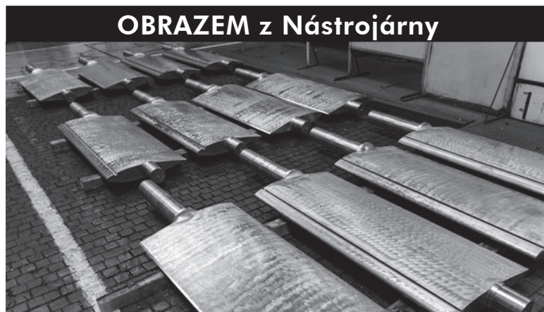
Rozváděcí lopatky pro vodní elektrárnu Kamýk ze soustrojí TG 2 připravené na expedici do firmy Litostroj Engineering Blansko.
