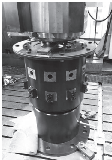
Hydraulický rotační převaděč vyrobený ve ŽDAS, a.s. bude pohánět zvedací stoly na jevišti ve Státní operě v Praze.
