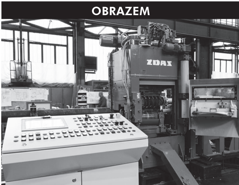
Na montáži haly 4 bylo počátkem července dokončeno oživení a zkoušky rovnačky XPK 2-40 určené pro čínskému zákazníka Shan Dong Shou Guang Ju Neng Steel Co. Ltd. Ostatní zařízení rovnací linky jsou vyráběna podle naší dokumentace v Číně. Linka je určena pro rovnání ocelových kruhových tyčí o průměrech 13 až 40 mm v délkách 5 – 10 metrů o vysoké pevnosti.
