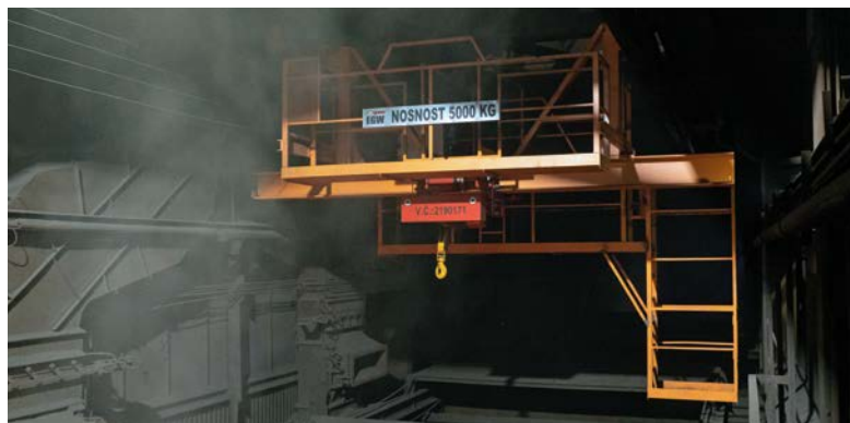
Na Ocelárně byl loni během prosincové odstávky nainstalován nový mostový jeřáb o nosnosti pět tun, který slouží k manipulaci s elektrodami do elektrických obloukových pecí. Demontáž starého jeřábu a instalace nového byla v těžkém prostředí s vysokou teplotou a prašností velmi náročná. Nový jeřáb nahradil ten původní z roku 1956, který už byl pro opravy a provoz nevyhovující.
