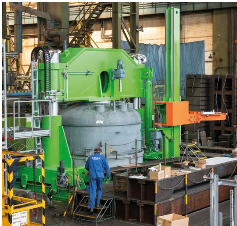
Na montáži haly 5 probíhá kompletace prvního vulkanizačního lisu určeného pro společnost Trelleborg Wheel System. Přejímka za účasti zákazníka je plánována na polovinu června.
