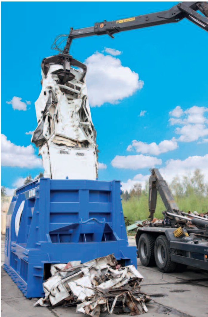
Zavážení nůžek CNS 400 K automobilovým šrotem
