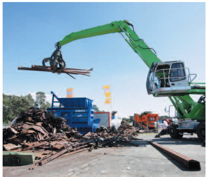
Zavážení nůžek CNS 400 K dlouhým šrotem
