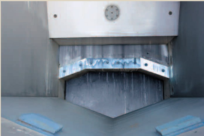
Pohled na střížné nože umístěné po celé šířce zavážecí komory
