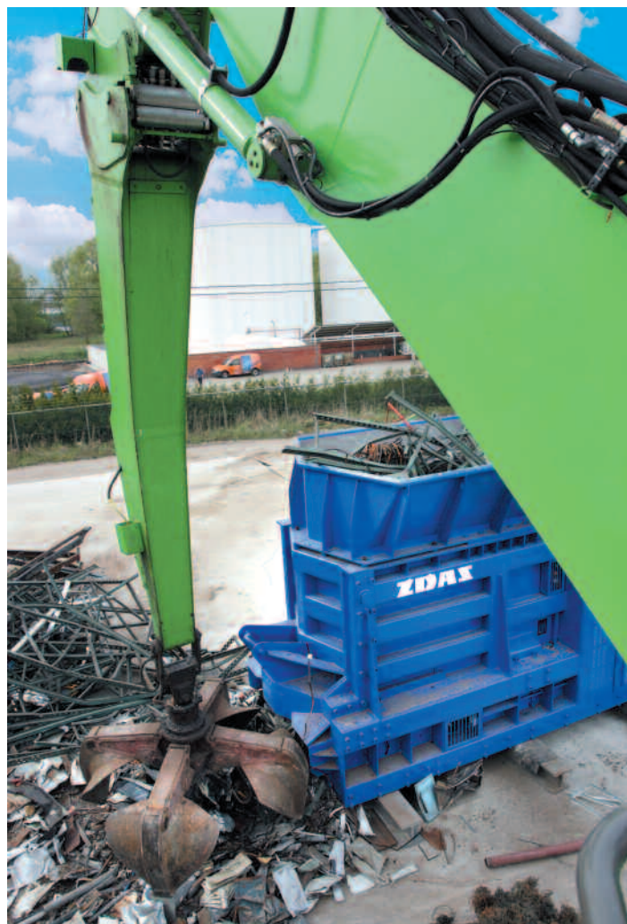
Zavážení nůžek CNS 400 K drapákovým nakladačem
