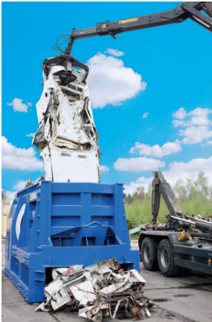
Загрузка ножниц CNS 400 К кузовами автомобилей
