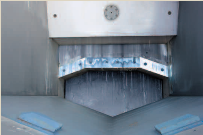
Вид на срезные резцы, размещенные по всей ширине загрузочной камеры
