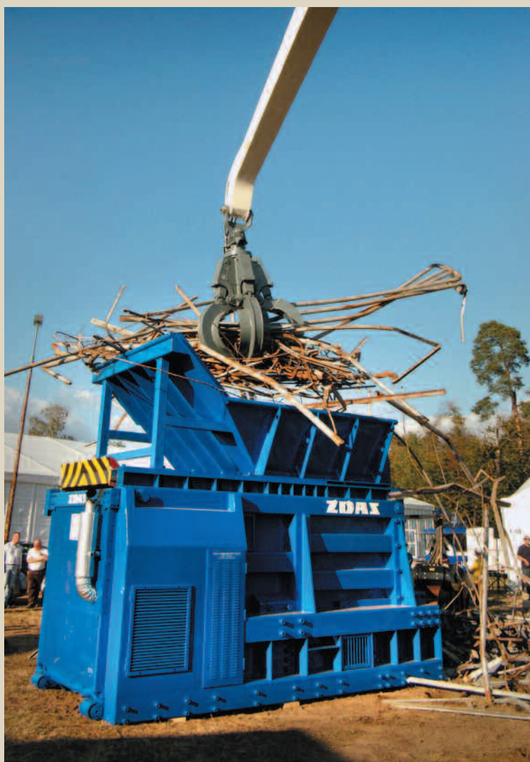
Контейнерные ножницы CNS 400 K с наружной воронкой при загрузке прутковым ломом
