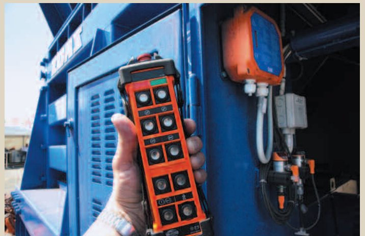
Дистанционное управление ножницами обеспечивает безопасную работу и управление одним оператором
