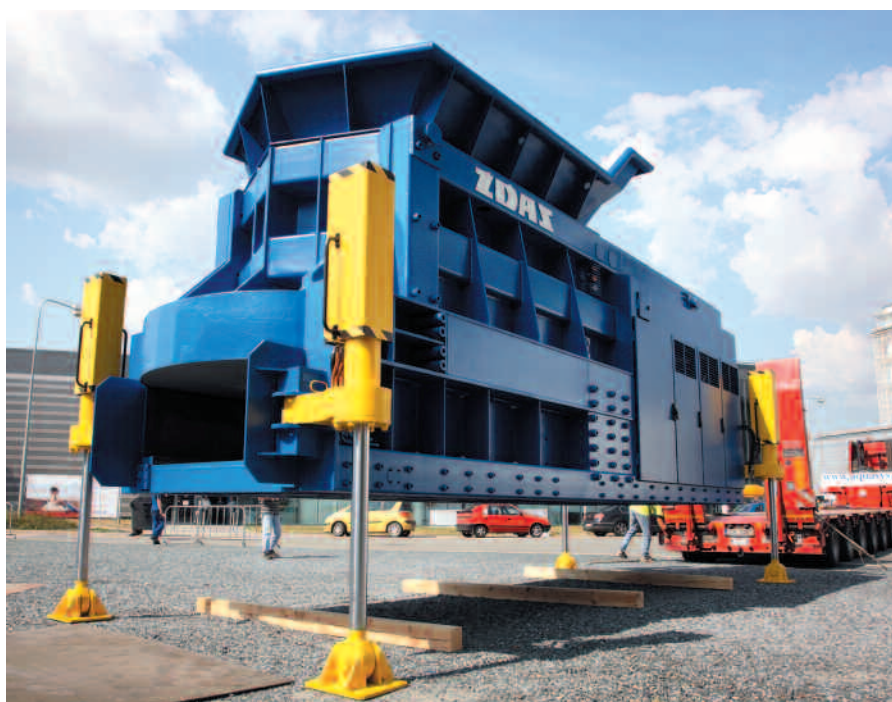
Nůžky CNS 730/190 připravené k naložení na podvalník
