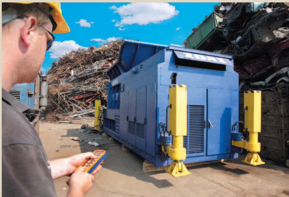
Dálkové ovládání nůžek operátorem na šrotišti
