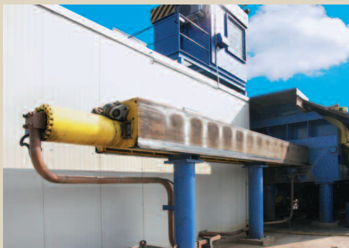
Hydraulický pohon tlačky
