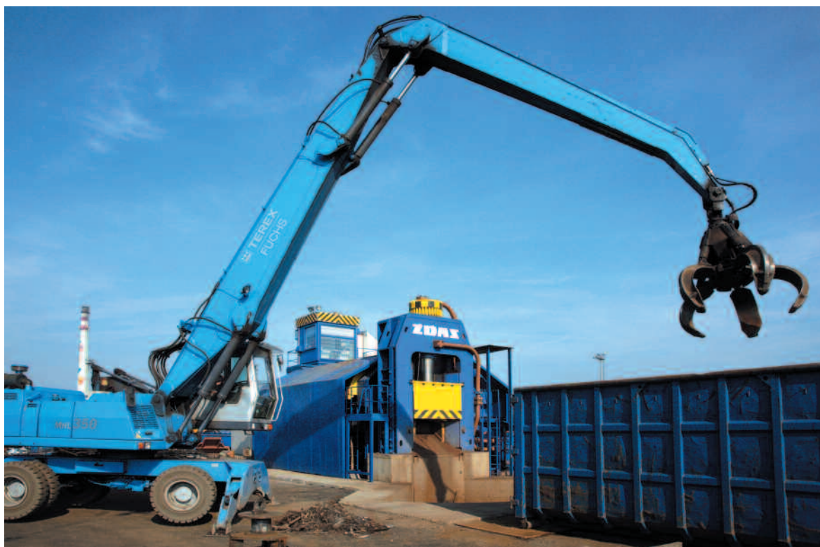
Pracoviště s hydraulickými nůžkami CNS-PVM
