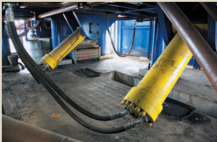
Гидравлические цилиндры управляют опрокидывающей крышкой
