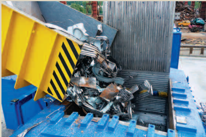
Sklopná násypka lisu CPB 200 umožňuje snadné nakládání šrotu.
