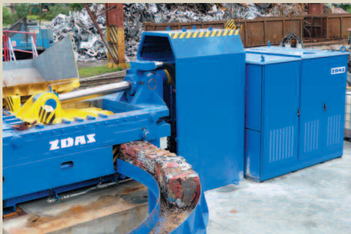
Součástí lisu je i dopravník hotových paketů.
