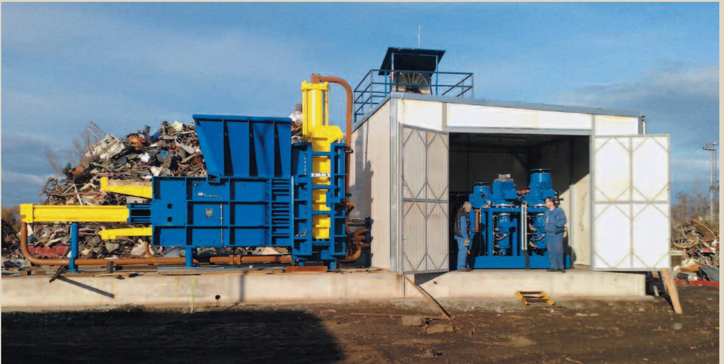
*Привод машины находится в отдельной кабине*
