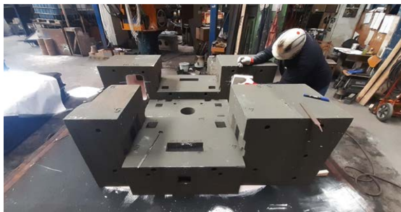
Výroba pískové formy prototypu byla provedena metodou využívající jádra vytištěná 3D tiskem.
