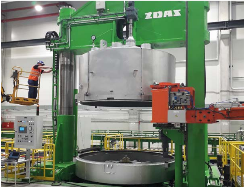
Ve společnosti Trelleborg v Otrokovicích v těchto dnech finišují práce na zprovoznění vulkanizačního lisu na lisování pneumatik pro zemědělské stroje.
