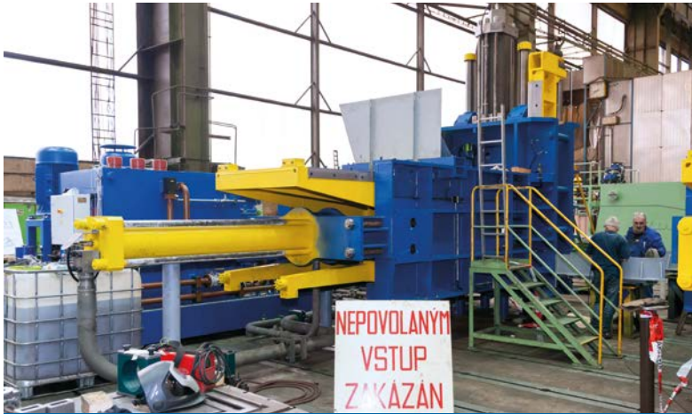
Paketovací lis CPS 360 určený pro lisovnu automobilky Hyundai na montáži haly 5
