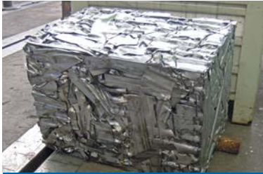
Výsledný paket šrotu ze stacionárního lisu CPS 360
