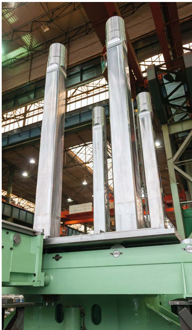
Sloupy kováčského lisu CKV 1250/160, který se v současné době montuje v provozu haly 5 a bude součástí kováčského souboru pro ruského zákazníka
