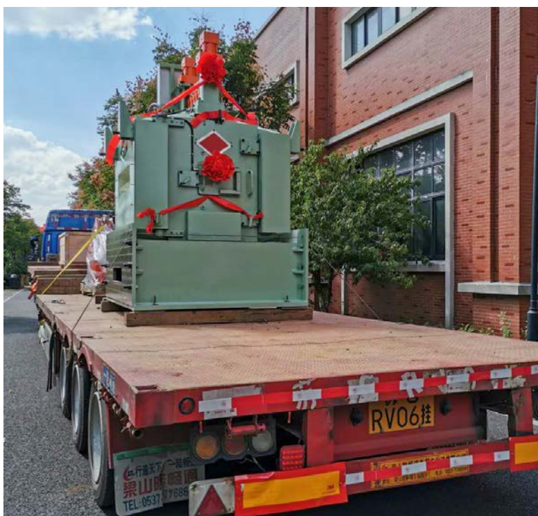
Pohled na smontovaný celek válcovací stolice plechů za studena
