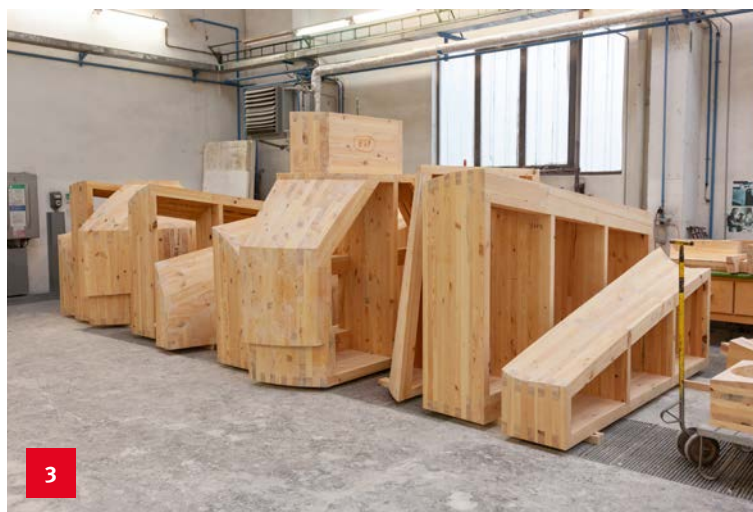
Foto č. 1: 3D model držáku kormidla (6046 x 7500 x 3500 mm)
