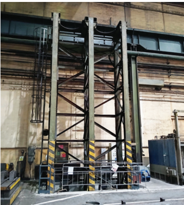
Upravené stojany na chlazení výkovků ve vertikální poloze
