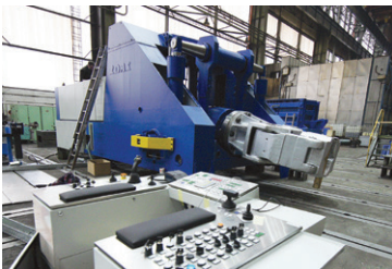
Manipulátor QKK 12 po opravě a modernizaci při zkouškách na ŽĐASe
