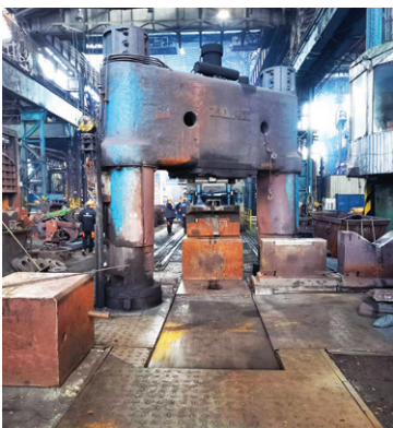
Lis CKW 1600 před zahájením modernizace
