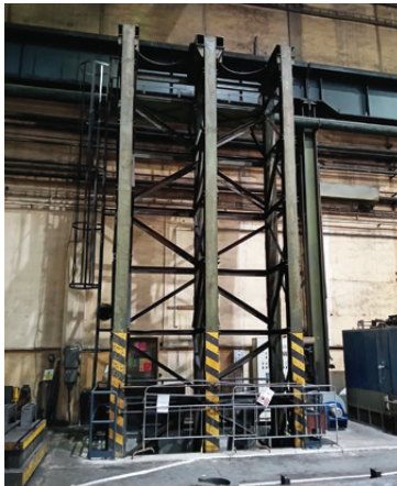
Upravené stojany na chlazení výkovků ve vertikální poloze
