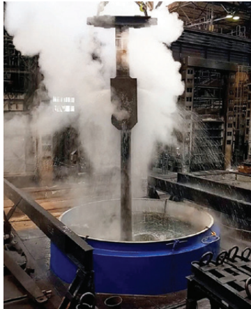
Tepelné zpracování dlouhých výkovků ve vertikální poloze
