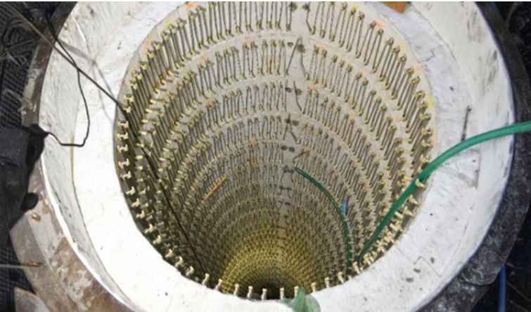
Rekonstruovaná hlubinná pec č.1
