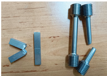
Zkouška rázem v ohybu a tahová zkouška
