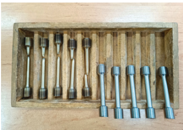
Zkouška tahem za zvýšené teploty
